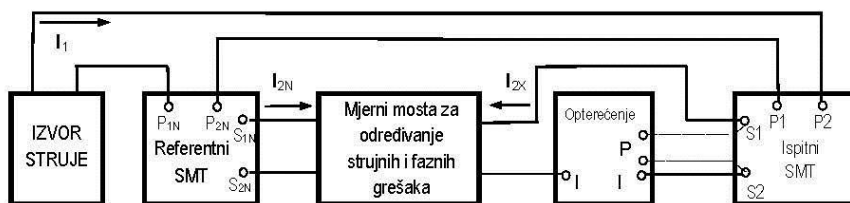
Slika 1. - Princip utvrđivanja grešaka strujnog mjernog transformatora
